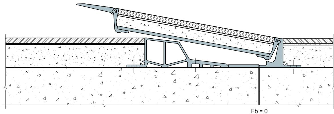
6. Экстремальное сейсмическое расширение на +75 мм
