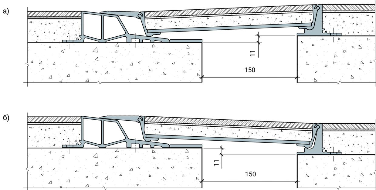
5. Экстремальное сейсмическое сжатие на -150 мм
