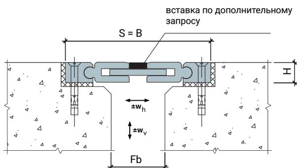
Вариант установки с опорным уголком
