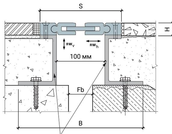
Опорные стальные уголки (другие какие-либо стальные конструкции) не входят в стандартную комплектацию данной серии.
