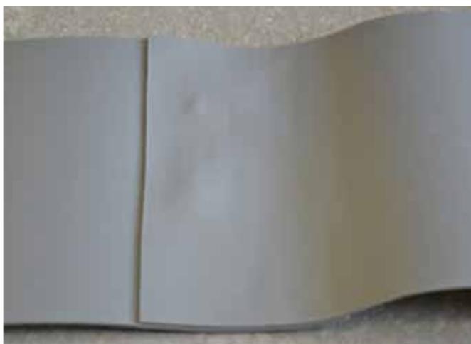
5. В результате сварки должен получиться монолитный шов.
